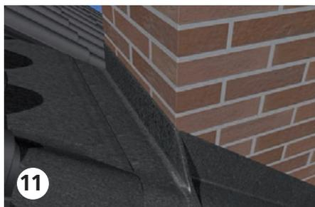
**11** ❶ Kehlstreifen mit einer 2 cm breiten Aufkantung unter der Dacheindeckung versehen ❷ Kehlbereich mit Deckmaterial bedecken (Überdeckung je nach Dachneigung 100 - 200 mm)
