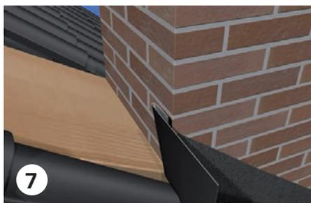
**7 Kaminrückseite** ❶ Vollflächigen Unterbau gewährleisten ❷ Dreikantleiste im Kehlnick wird empfohlen, insbesondere bei steilen Dachneigungen ❸ Wassersackbildung vermeiden
